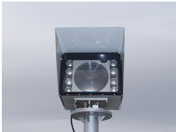
Рисунок 1 - Восьмипробінний лазерний приймач для атмосферного оптичного зв'язку. Швидкість передачі - до 1 Гбіт / с на відстані близько 2 км. Великий диск в центрі - приймач, малі диски зліва і справа - передавачі, гурток зверху справа - вікно оптичного монокуляра для виставлення двох блоків по загальному променю
