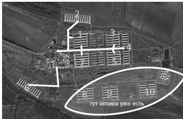
Рис. 1 – Схема существующей телекоммуникационной сети
